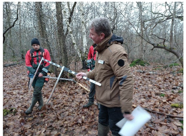
Présentation du compas, utilisé pour mesurer le diamètre de l'arbre
